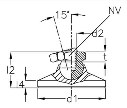
d1 = 25 d2 = 8 l2 = l4 = -NV = 12 Static load (kN) = 14 t min = 9
